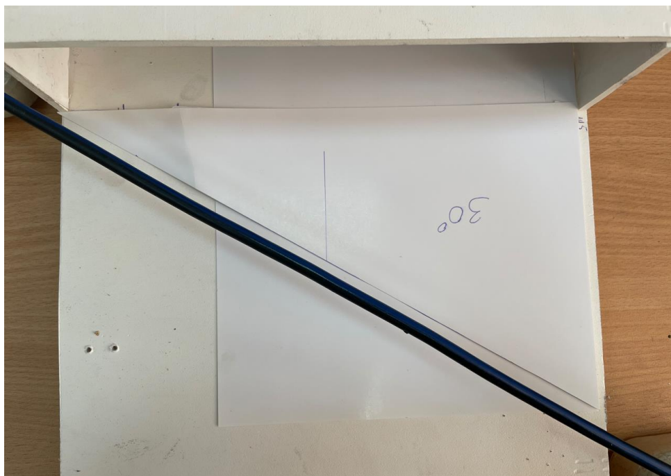
Рисунок 6 – Расположение провода относительно направления ветра под углом
