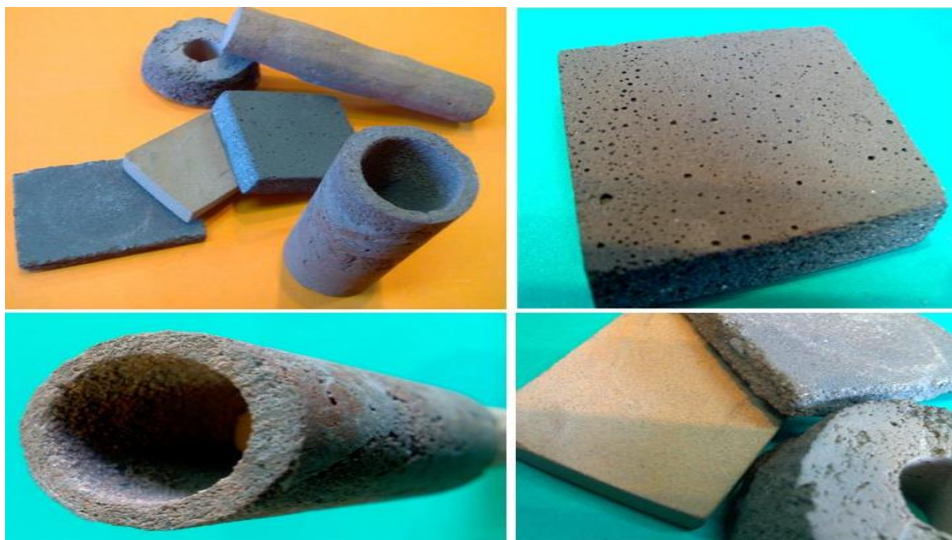
Рисунок 11 – Образцы огнеупоров, полученные методом СВ-синтеза из БШ
