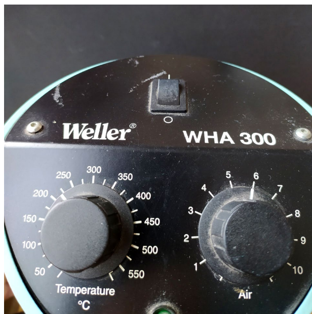
Рисунок 4 – Фен Weller WHA 300, применяемый для нагрева спирали
