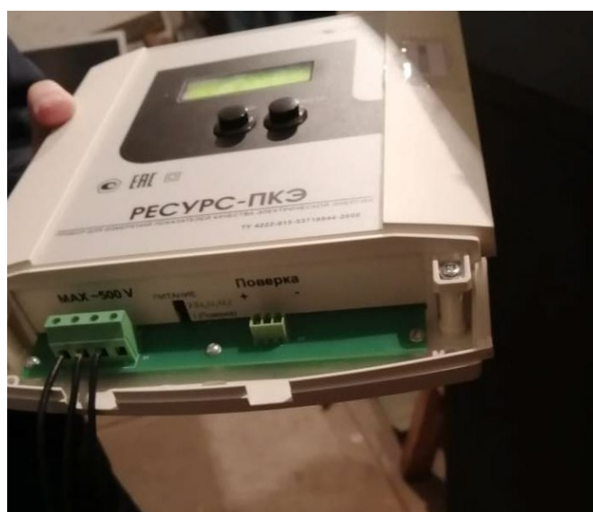
Рисунок 3 – Передняя панель прибора «Ресурс-ПКЭ»
