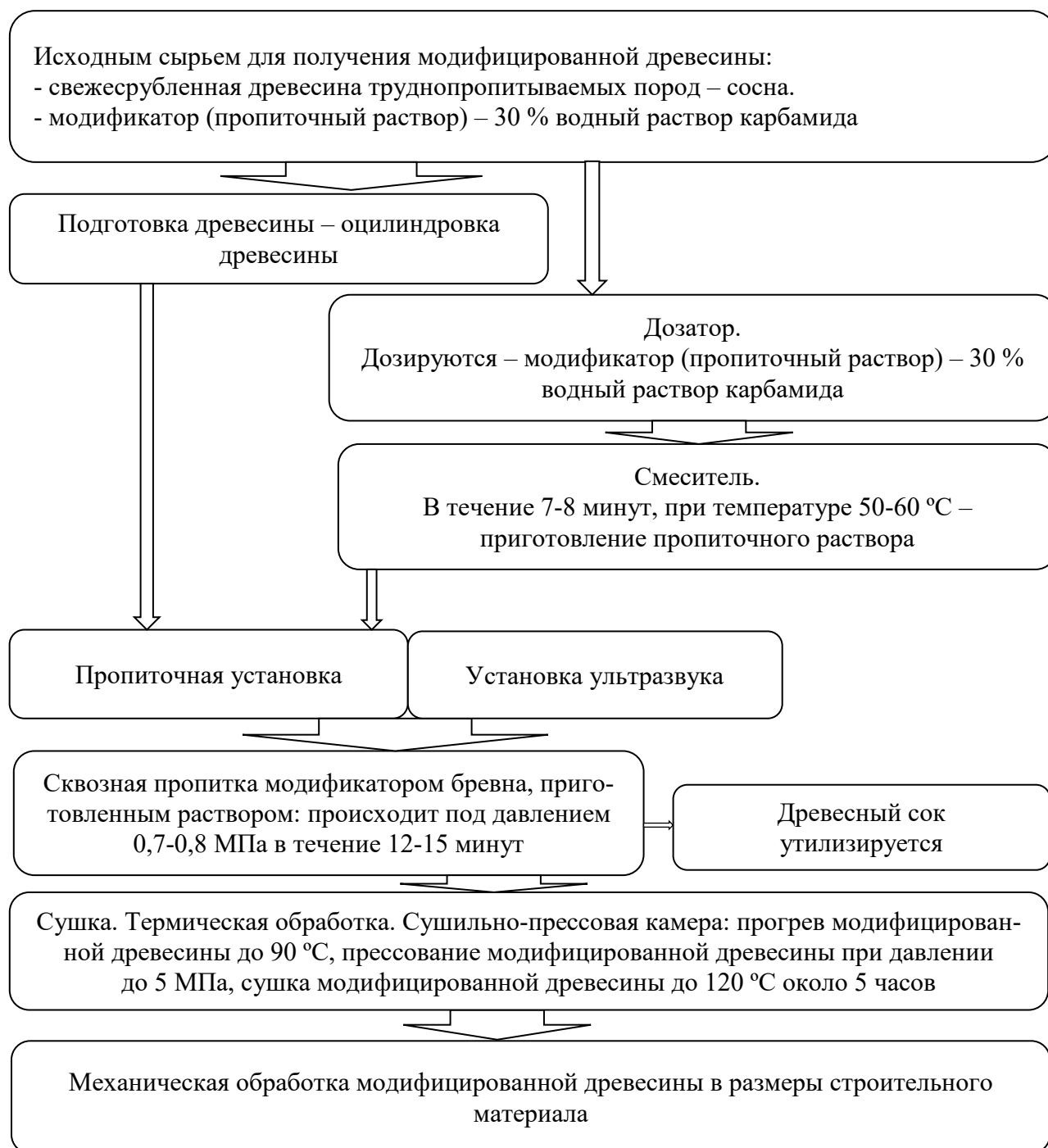
Рисунок 2 – Технологическая схема получения модифицированной древесины из труднопропитываемых пород
