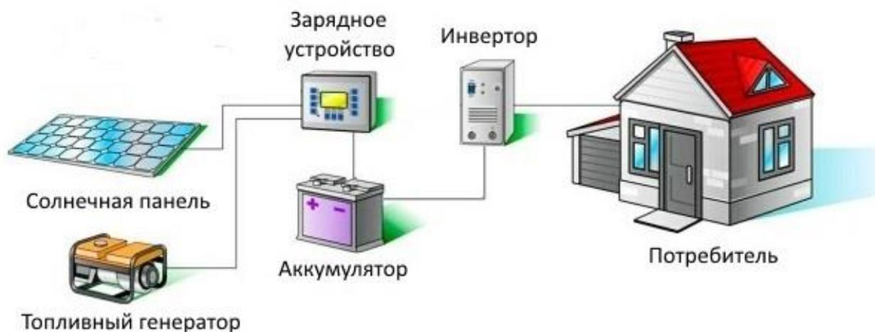
Рисунок 1. Система гибридной солнечной электростанции на базе топливного генератора
