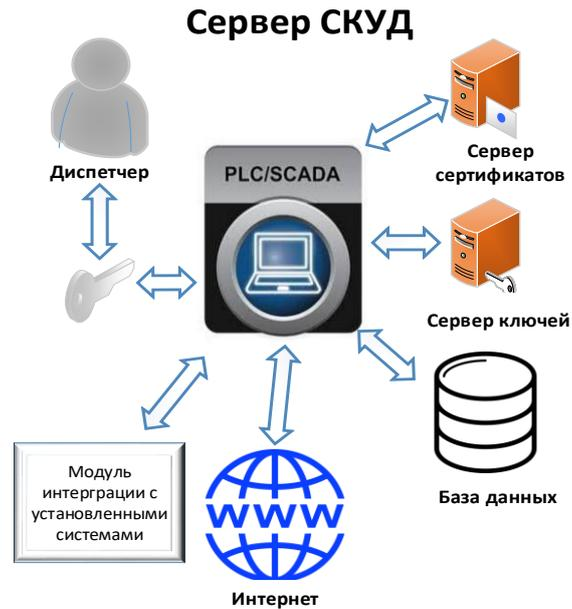
Рисунок 4. Структурная схема сервера СКУД
