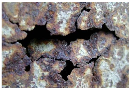
Рисунок 2 – Химическая коррозия: 4\text{Fe} + 3\text{O}_2 \rightarrow 2\text{Fe}_2\text{O}_3
