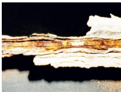
Рисунок 11 – Щелевая коррозия металлической поверхности
