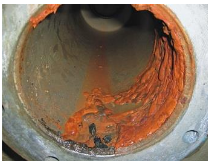
Рисунок 1 – Электрохимическая коррозия: 4\text{Fe}_2^{++} + 6\text{H}_2\text{O} + 4\text{e} = 4\text{Fe}(\text{OH})_3
