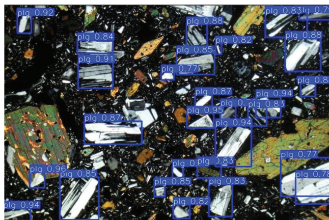
Рисунок 2. Результаты обнаружения объектов на тестовых изображениях: а) модель YOLOv8n, обученная на наборе из 318 изображений; б) та же модель, обученная на наборе из 20 изображений
