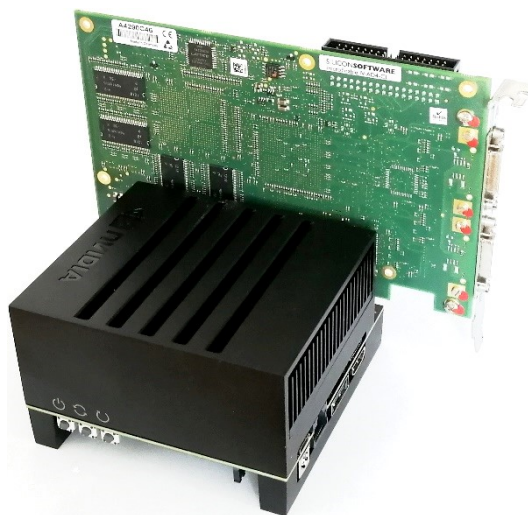
Рисунок 5 – Высокоскоростные средства сбора и обработки видеоданных интеллектуальной тепловизионной системы на базе Jetson AGX Xavier и microEnable IV-AD4-CL
